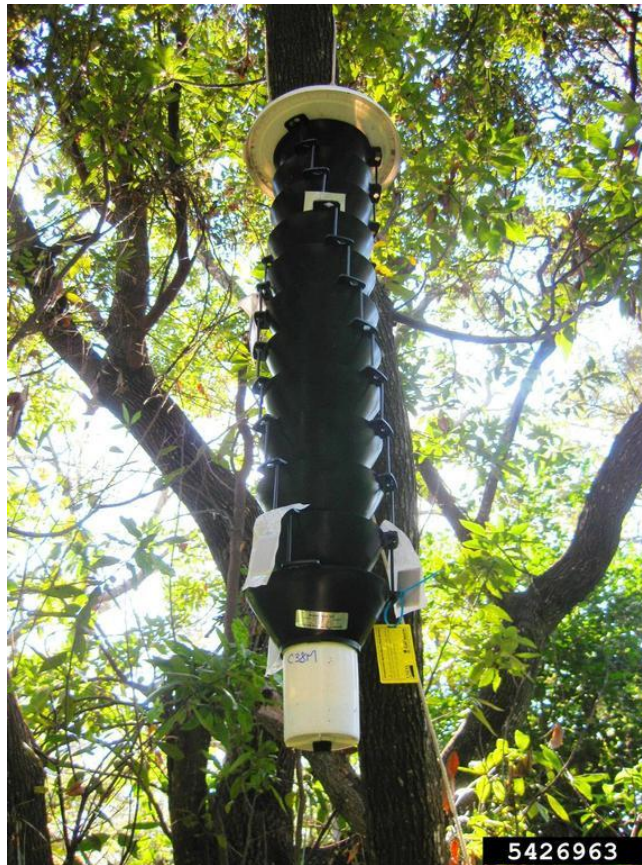
Figura 26. Trampa de embudo Lindgren cebada con aceite de manuka suspendida de un árbol de laurel rojo ( Persea borbonia ) en Miami, Florida para monitoreo de la actividad de vuelo de Xyleborus glabratus (Derksen, 2005).
