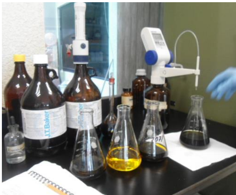
Figura IV.6. Determinación de materia orgánica utilizando titulador automático eppendorf top buret M.
