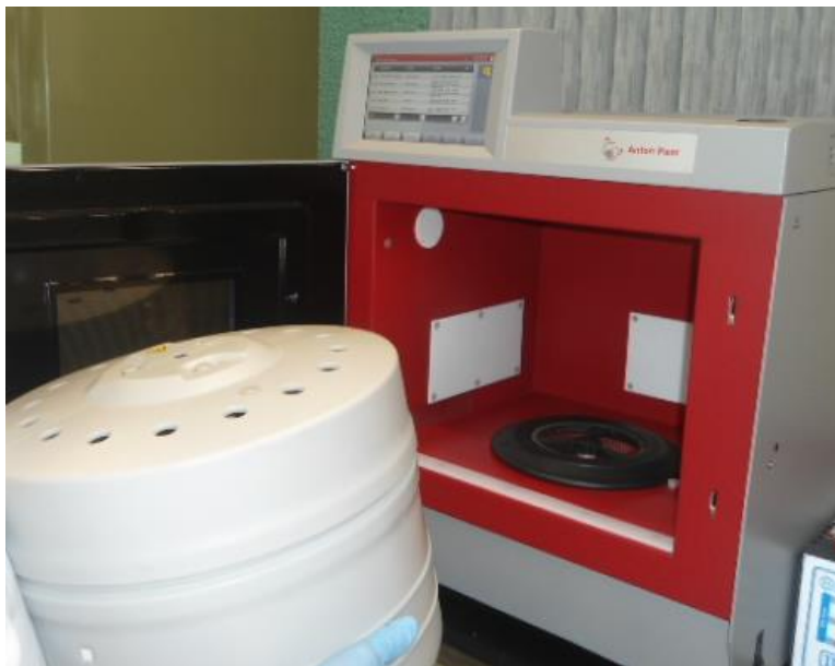
Figura IV.11. Digestión en un sistema cerrado utilizando un horno de microondas Multiwave PRO Anton-Paar.
