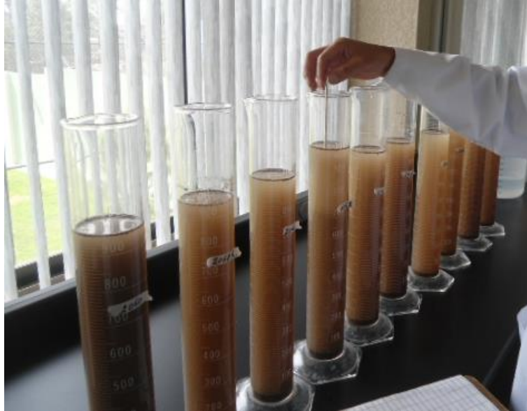
Figura IV.8. Toma de lectura de la muestra con hidrómetro.
