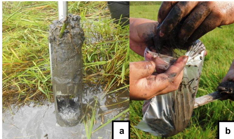
Figura 8. Colecta de suelo por capas, a) con barrena de acero inoxidable y b) almacenamiento de muestra.
