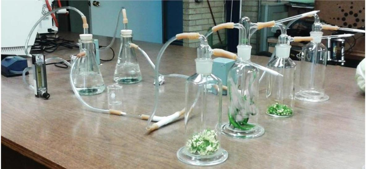
**Figura 3.** Extracción de COVs de los órganos de chile por aireación dinámica.
