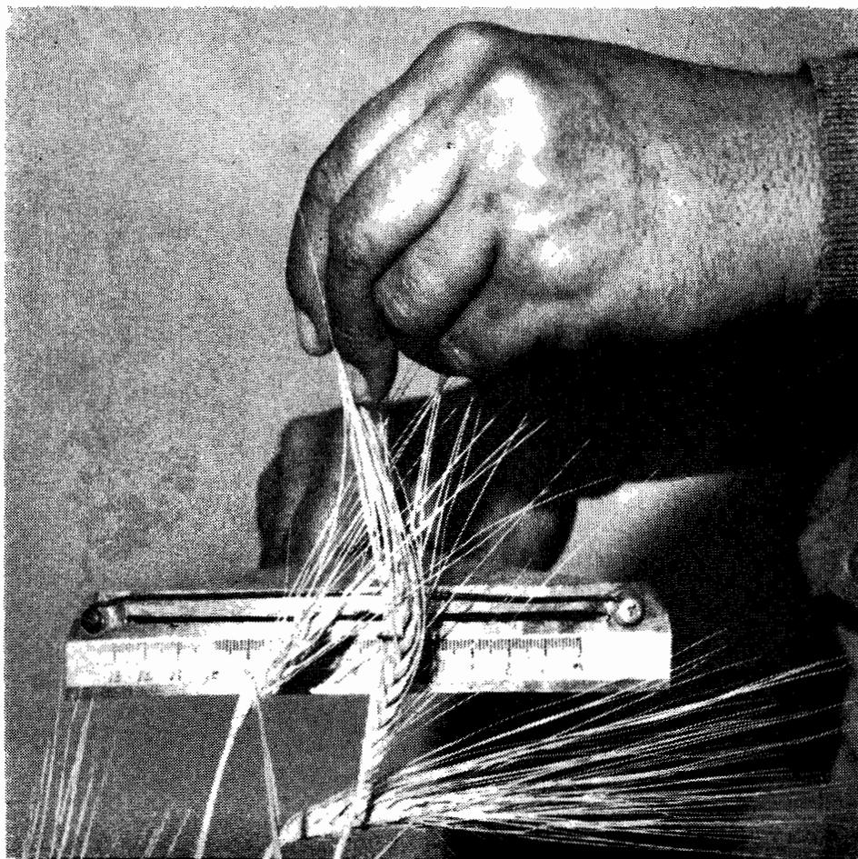
Figura 2. Forma en que se midió la resistencia del raquis a la ruptura; nótese una espiga rota.
