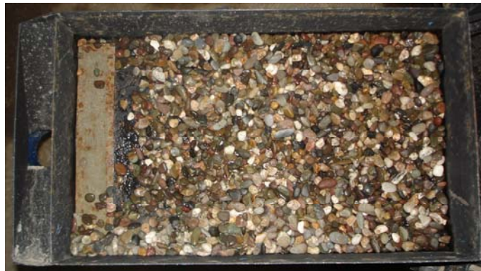
Figura A.8 Colocación de malla de fierro y grava en lote de escurrimiento.
