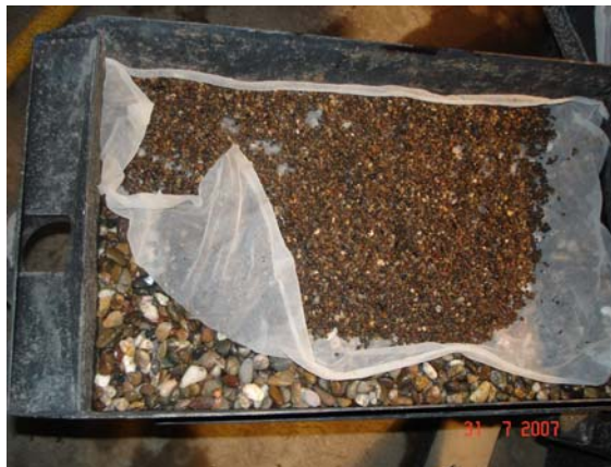
Figura A.9 Colocación de gravilla en lote de escurrimiento.
