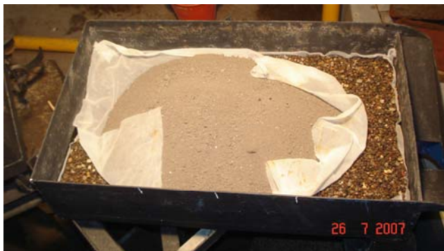
Figura A.10 Colocación de suelo en lote de escurrimiento.
