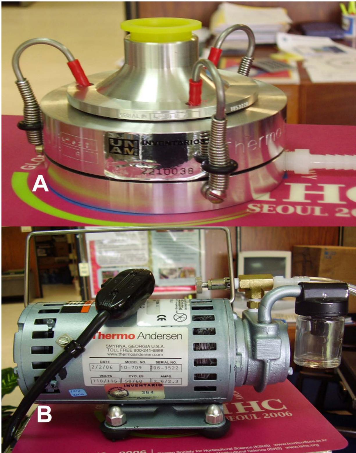
**Figura 2A.** Equipo utilizado en el monitoreo aerobiológico. A) Caja impactador y B) Bomba extractora de aire, Thermo Andersen® de una etapa.
