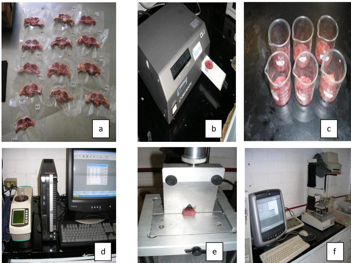
Figura 9. a) Muestras de carne empacadas al alto vacio, b) lector de Aw, c) carne preparada para medir pH, d) colorímetro, e) textutometro, f) lector de CRA.
