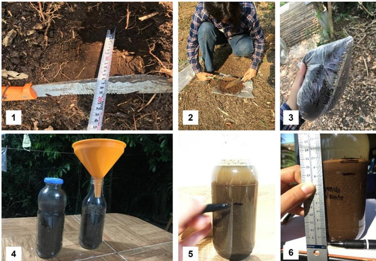
**Figura 4.** Procedimiento para determinar las características fisicoquímicas de las muestras de suelos seleccionadas en cada sitio del terreno
