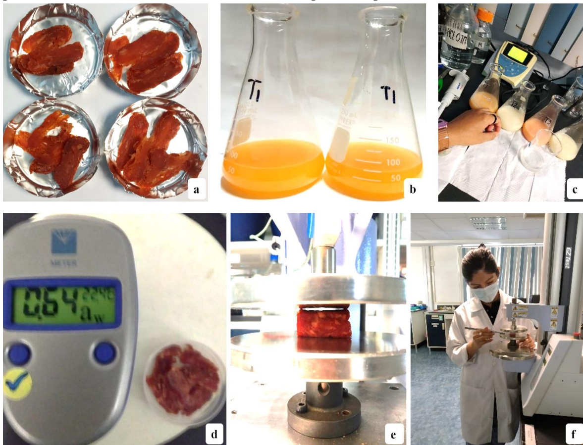
Figura A7. Análisis fisicoquímico de las muestras de chorizo tipo español. a. Cuantificación de humedad, b. determinación de acidez titulable, c. Medición de pH, d. Lectura de a_w , f-g. Medición del análisis de perfil de textura (TPA).
