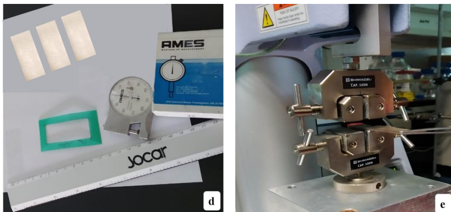
Figura A3. Ensayos de caracterización de las películas biodegradables: a. Determinación de humedad, b. Prueba de solubilidad en agua, c. Determinación de permeabilidad al vapor de agua (WVP), d) Medición de espesor y e. Evaluación de las propiedades mecánicas.
