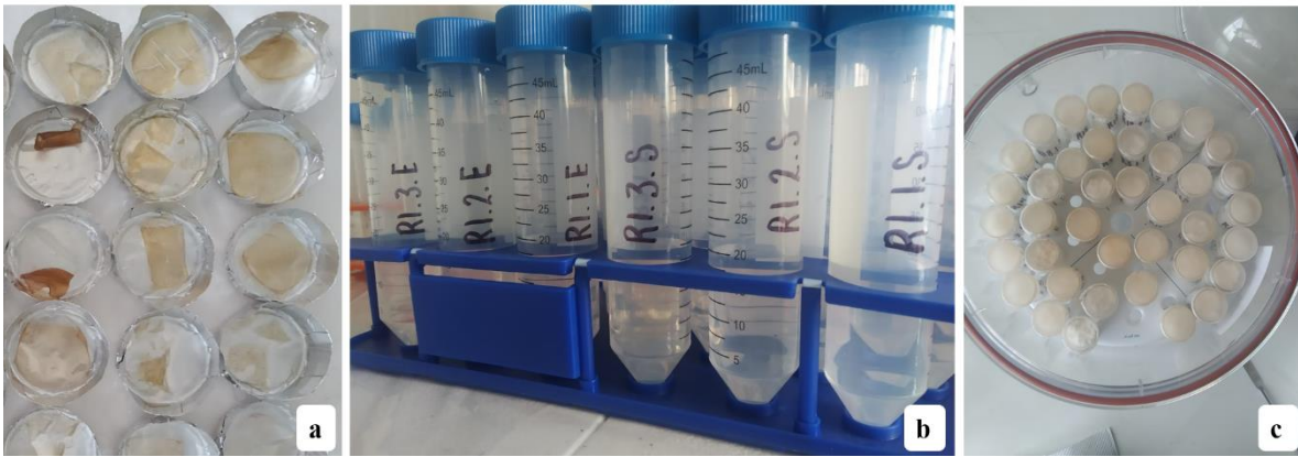
Figura A2. a. Elaboración de las películas biodegradables (conjunto de puntos de prueba del diseño Box-Behnken), b. Secado de las películas biodegradables. c. Apariencia visual de las películas biodegradables.
