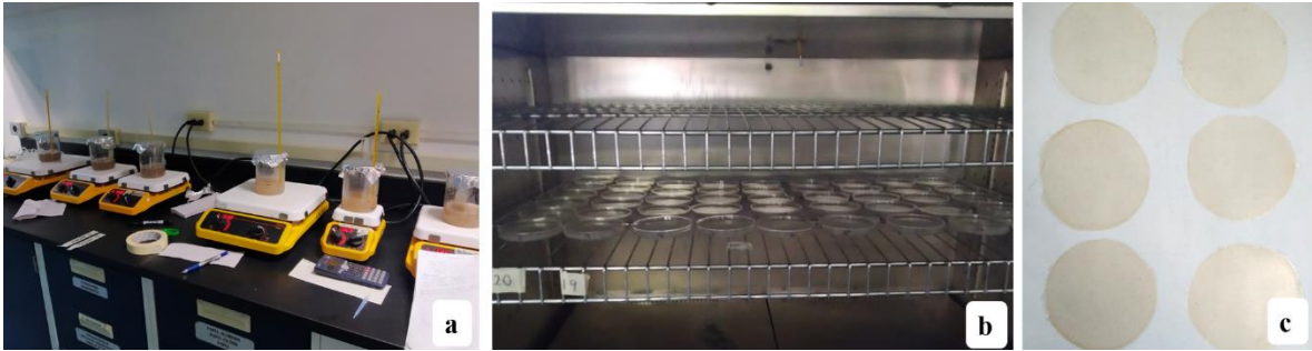
Figura A2. a. Elaboración de las películas biodegradables (conjunto de puntos de prueba del diseño Box-Behnken), b. Secado de las películas biodegradables. c. Apariencia visual de las películas biodegradables.
