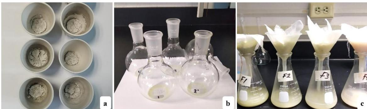
**Figura 8.** Caracterización fisicoquímica de los embutidos cárnicos. **a.** Determinación del contenido de cenizas; **b.** Cuantificación del contenido de grasa y **c.** Medición pH y acidez titulable.
