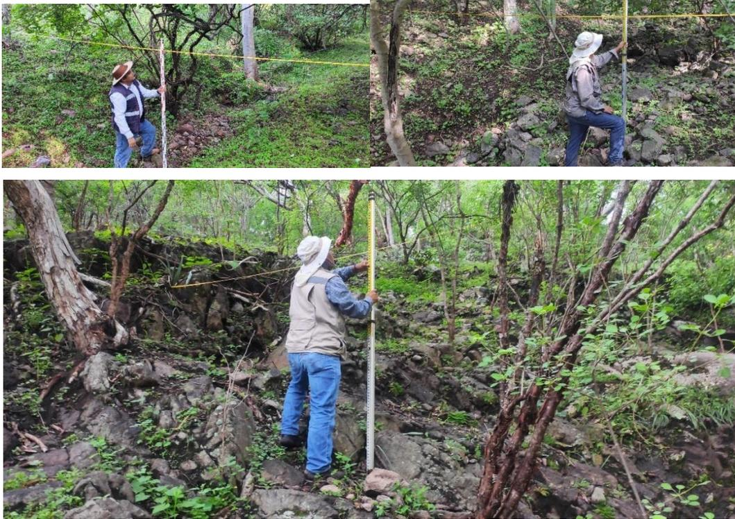
Figura 16. Seccionamiento de cauces. El seccionamiento se realizó a cada metro en cauces amplios y cada 0.5 m en cauces muy angostos.
