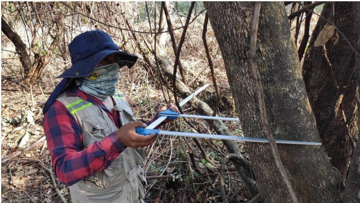
Figura 9. Ejemplo de forcípula utilizada para determinar diámetro de los árboles.
