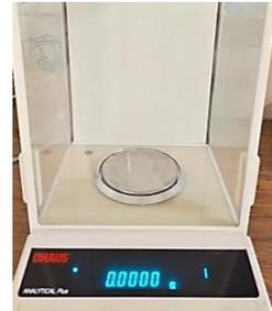
2. Colocar un vial nuevo de 1.8 mL (con tapa y etiquetado) sobre la balanza para registrar su peso.
