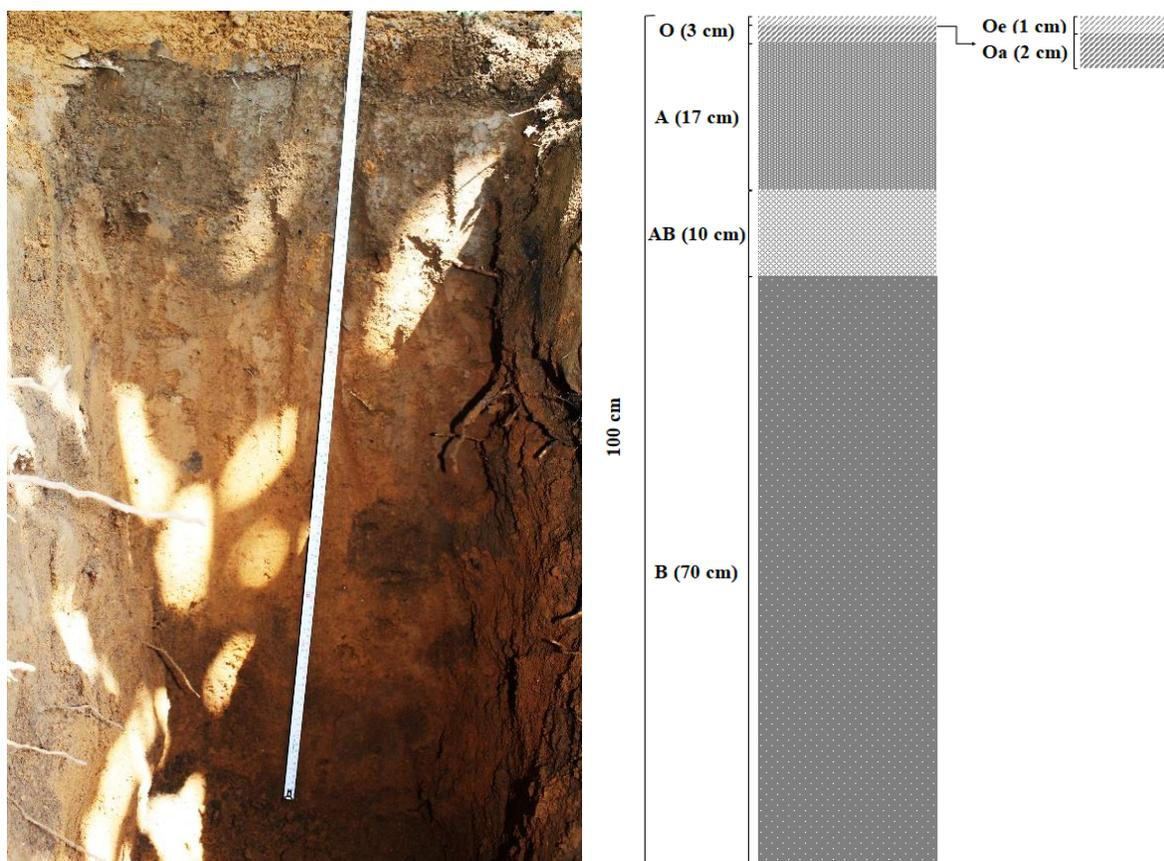
Figura 4. Perfil Aguacate Convencional, perfil y esquema de distribución de los horizontes.
