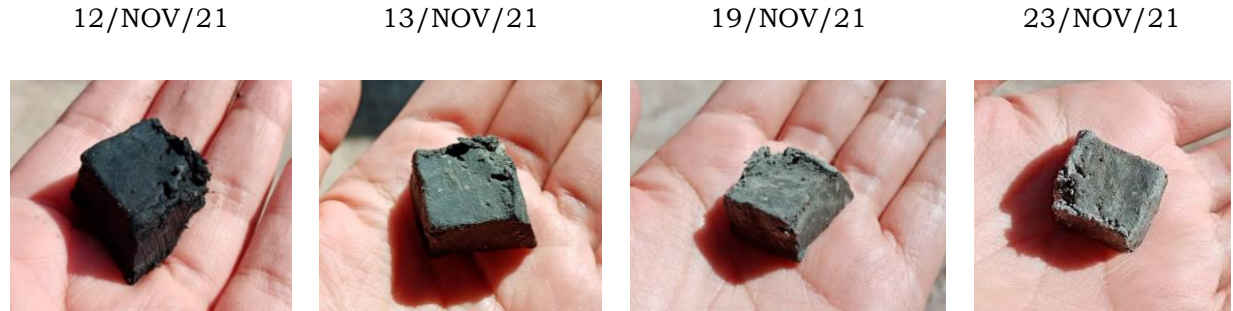
Figura 12. Evidencia fotográfica del cambio de color por oxidación.
