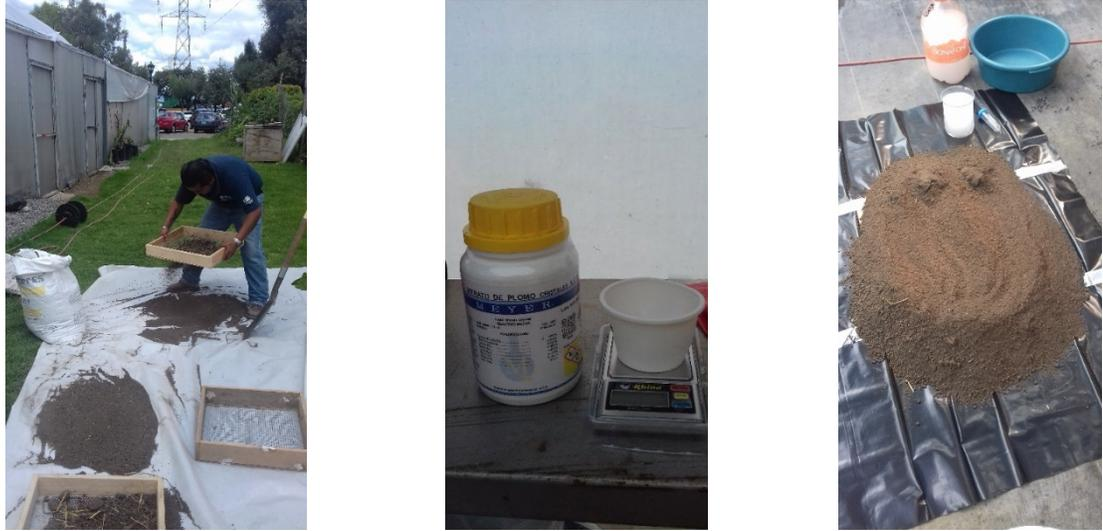
**Figura 8. Suelo cernido (a). Nitrato de plomo (b). Mezcla de plomo con suelo (c).**
