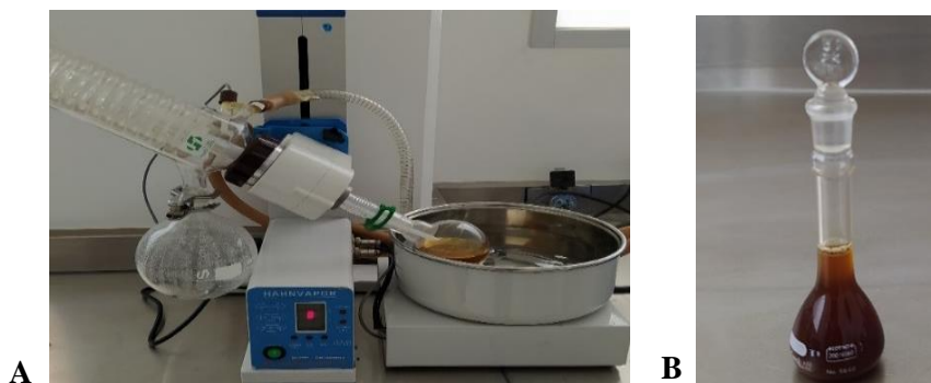
Figura 12. A: Concentración del macerado de biomasa seca de Trichoderma aggressivum f. aggressivum (CPM-115) en rotavapor. B: Extracto hidroalcohólico al 32% de la biomasa seca de la cepa CPM-115 de Trichoderma aggressivum f. aggressivum , aforado en un matraz de 10 mL.
