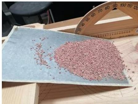
Figura 4. Equipo para determinación de fricción externa.
