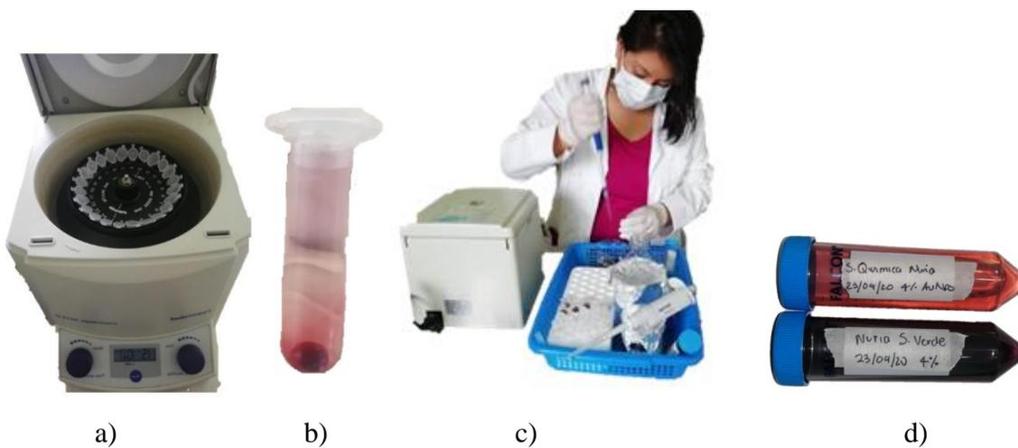
Figura 4. a) Centrifugado de muestras, b) Precipitado de AuNPs, c) Lavados continuos de AuNPs con agua destilada, d) Resuspensión de AuNPs en agua destilada.
