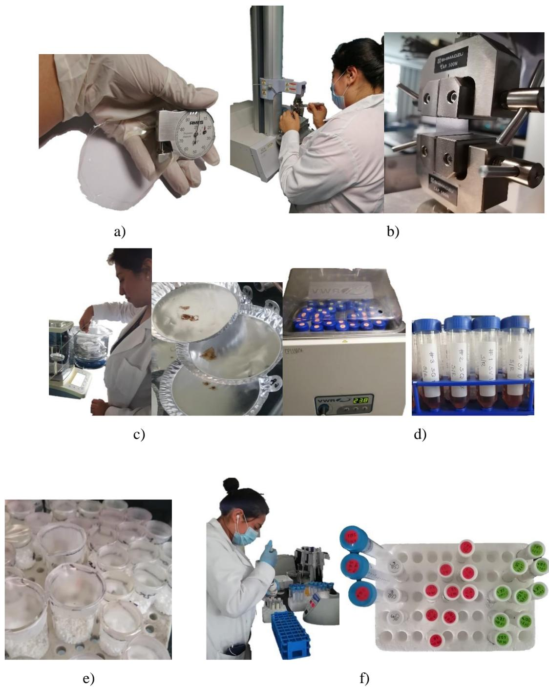
Figura 6. Análisis de películas biodegradables a) Espesor b) Propiedades mecánicas c) Humedad d) Solubilidad e) Permeabilidad f) Capacidad antioxidante
