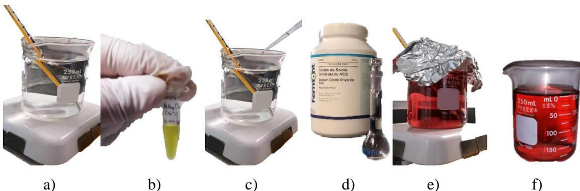
Figura 3. a) Agua destilada, b) Agente precursor al 4% ( $\text{HAuCl}_4$ ), c) Adición de  $\text{HAuCl}_4$ , d) Agente reductor (citrato de sodio), e) Formación de nanopartículas de oro, f) Suspensión coloidal de nanopartículas de oro.
