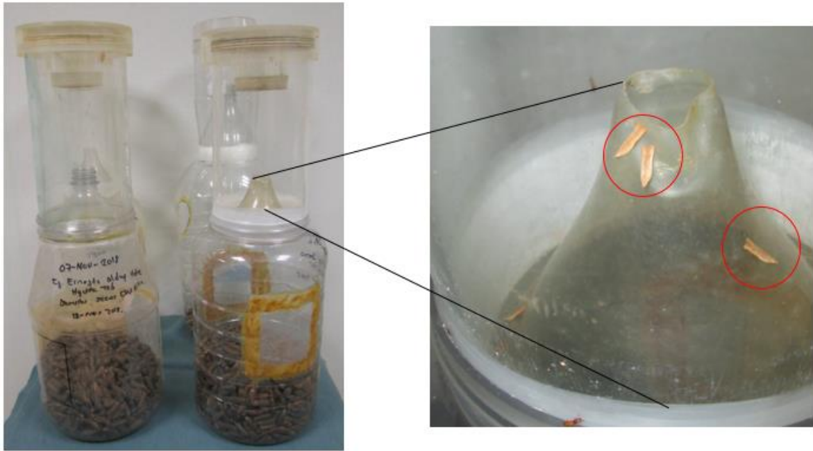
Figura 2. Dispositivo empleado para la obtención de insectos adultos cuyos estados inmaduros se desarrollan en el interior de frutos secos.
