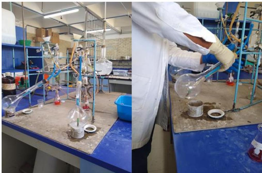
**Figura 18. Aparato de destilación para determinar CIC.**
