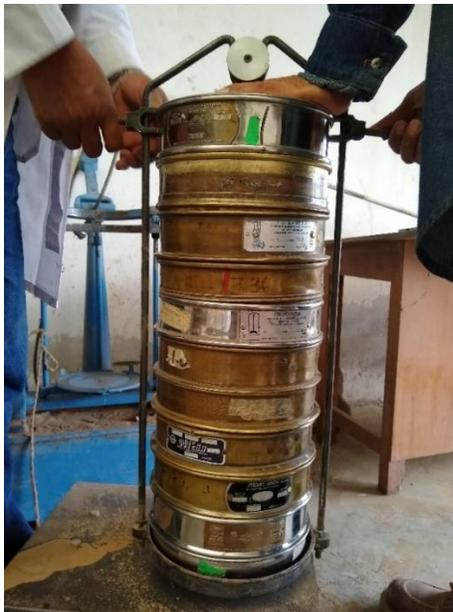
**Figura 12. Juego de tamices para ensayo granulométrico.**
