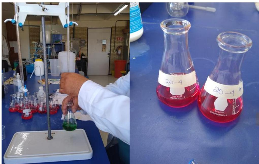
**Figura 19. Titulación con ácido sulfúrico para determinar CIC.**
