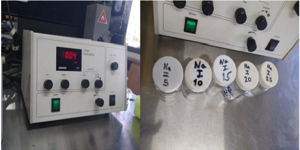
**Figura 20. Determinación de sodio y potasio por flamometría.**
