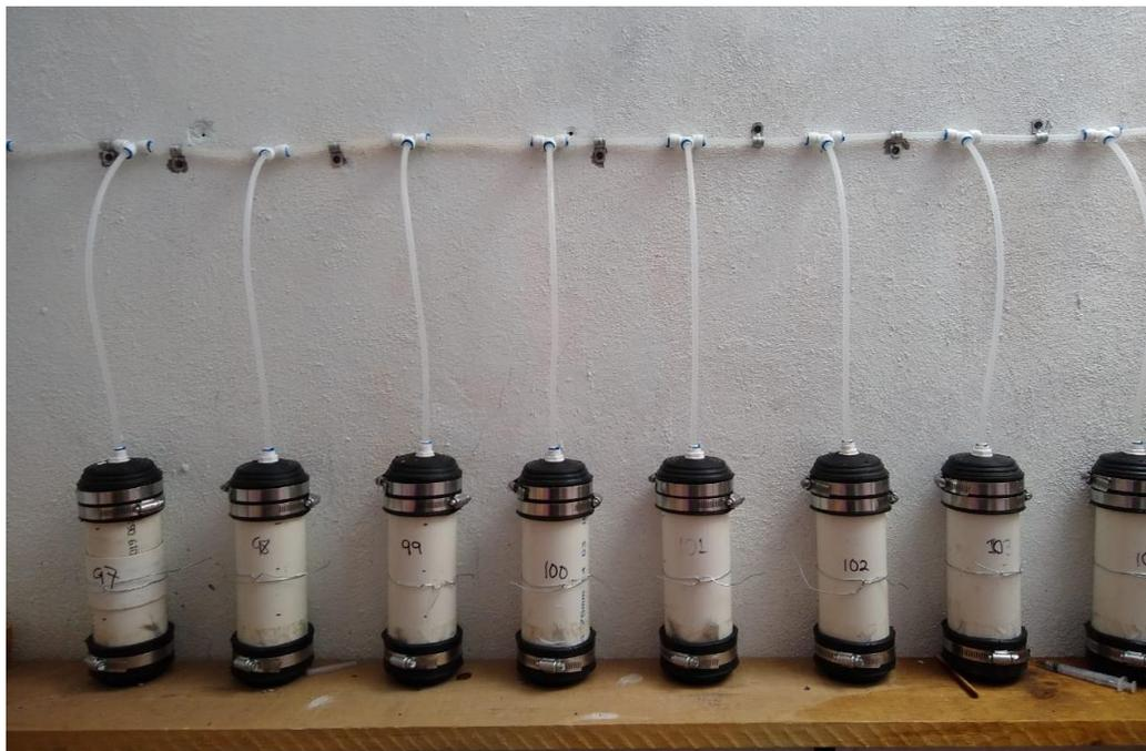
**Figura 31. Montaje de muestras al permeámetro de carga constante**
