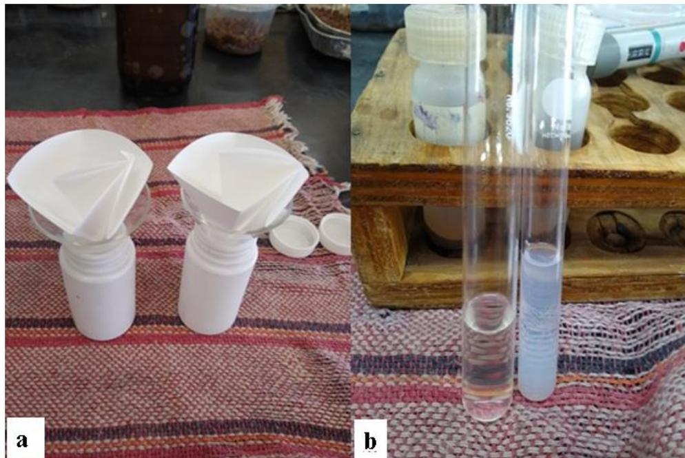
**Figura 17. a) Filtrado para determinación de bases intercambiables; b) Prueba de cloruros.**
