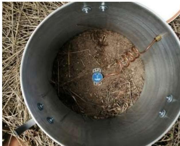
Figura 18. Colocación del sensor digital en el interior de cada cámara para medir la temperatura del suelo.
