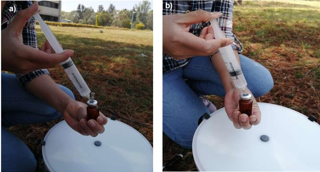
Figura 17. Toma de muestra. a) Inyección del aire de la cámara al vial. El vial tiene insertado la aguja de venteo para permitir la salida del aire de su interior (y que no corresponde a la muestra); b) Inyección de la muestra (aire del interior de la cámara) en el vial. Al inyectar la muestra ya se debe haber quitado la aguja de venteo del vial.
