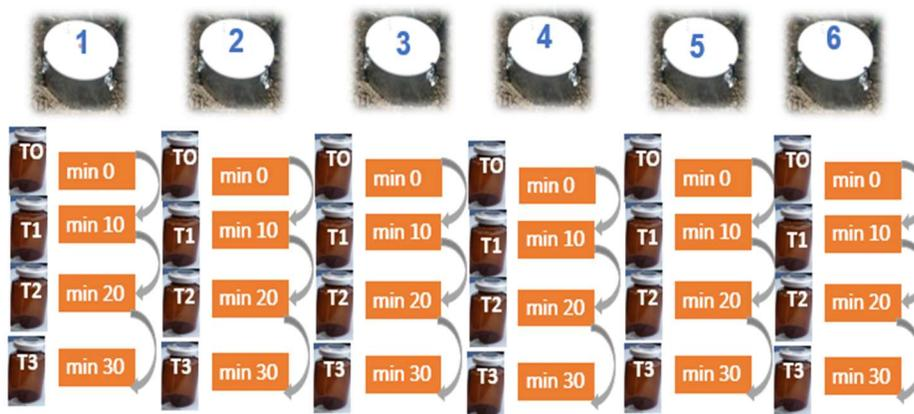
Figura 15. Recolección de las muestras de gas del interior de las cámaras, cuatro veces en intervalos de 10 minutos.
