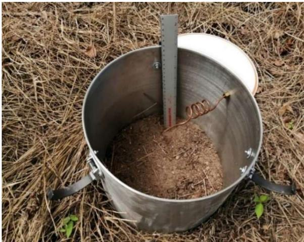
Figura 19. Medición de las alturas en cada cámara.
