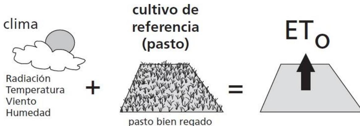
Figura 5.3. Evapotranspiración de referencia ( $ET_0$ ), (Allen, *et al.*, 2006).
