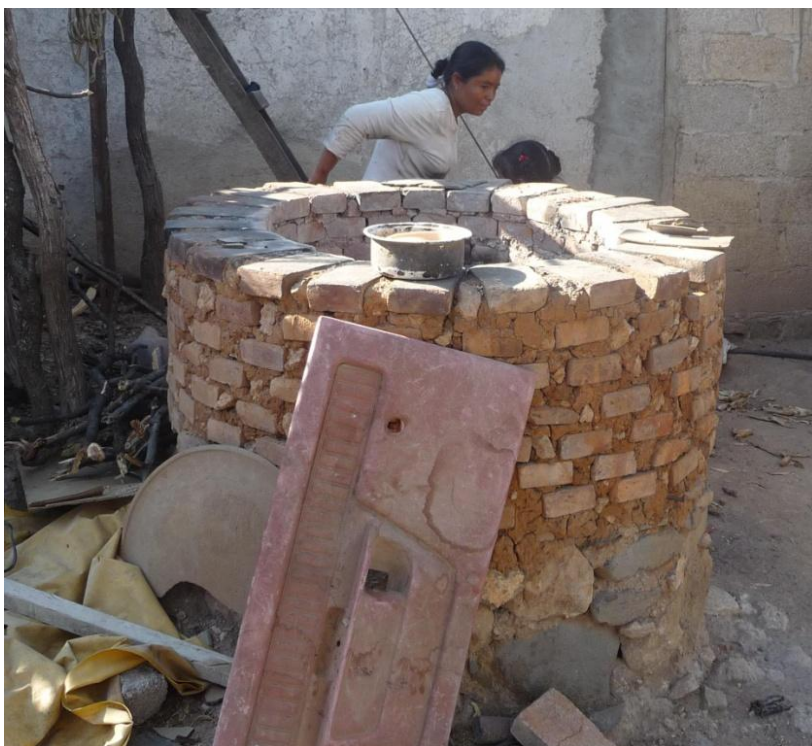
Figura 8. Horno abierto para la quema de la cerámica
