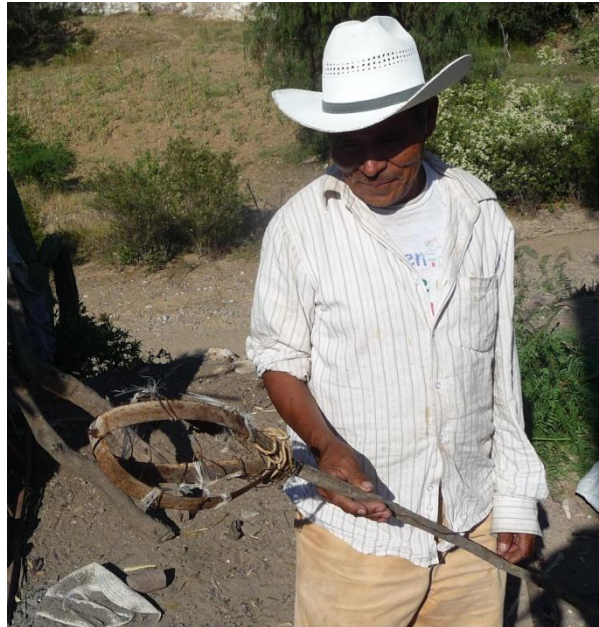
Figura 23. Herramienta de alcance para recolectar frutos hecho con quiote de Dasyllirion acrotriche
