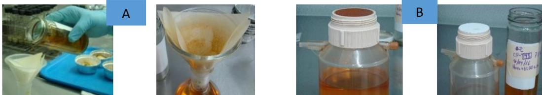
**Figura 7.** Métodos para la filtración del macerado de *Ganoderma lucidum* (CP-145). A) Filtrado por papel filtro poro de 20 µm. B) Filtrado por papel filtro poro de 0.45 µm.
