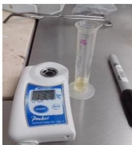
**Figura 11.** Refractómetro para medir grados Brix de las muestras de *Ganoderma lucidum* (CP-145).
