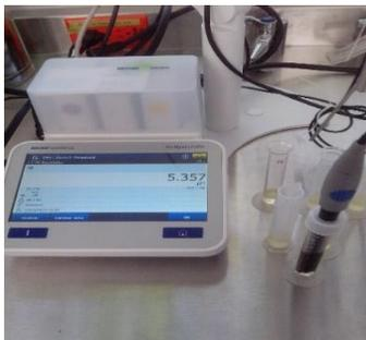
**Figura 10.** Potenciómetro utilizado para la medición de pH, conductividad y resistividad.
