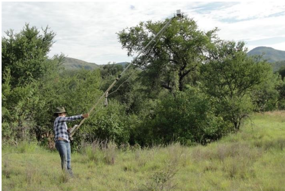
Figura 13. Registro de datos radiométricos e imagen nadir en un polígono sin obras.
