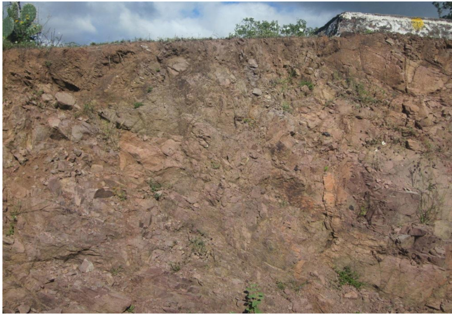
Figura 29. Presencia de grietas en el material rocoso de la zona de estudio.
