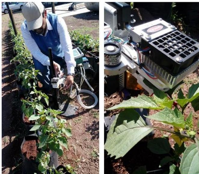
*Figura 13. Medición de variables fisiológicas con intercambiador de gases (IRGA) portátil (LI-COR LI6400).*
