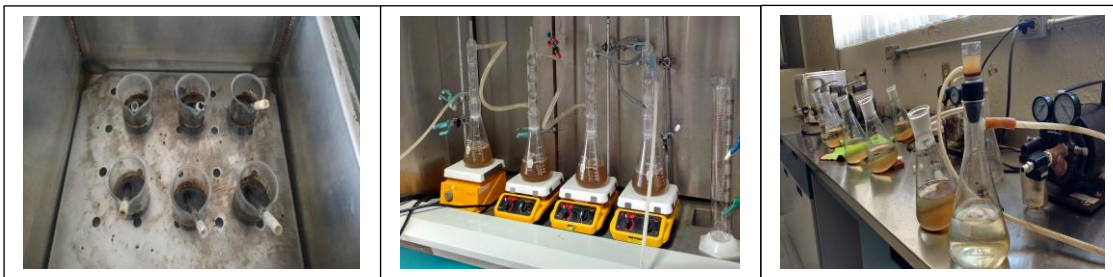
Figura 6. Equipo y proceso para determinación de lignina.
