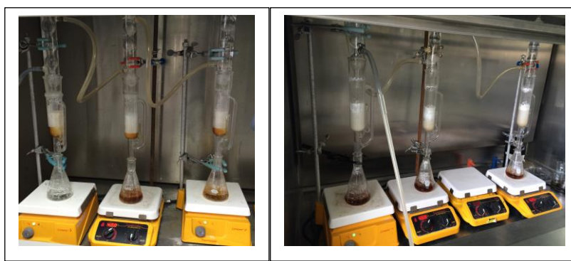
Figura 4. Equipo y materiales para extracción en agua.
