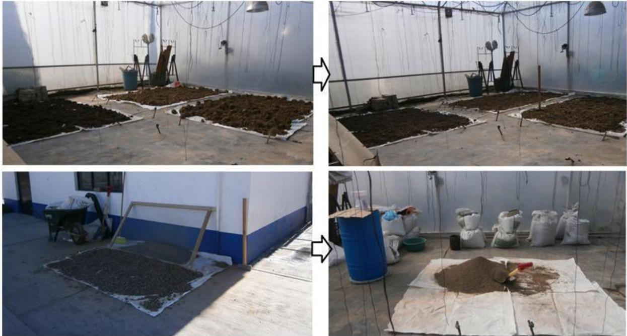
Figura 3. Procedimiento de secado, fragmentación, tamizado y homogenización de las muestras de suelos seleccionadas para la investigación.
