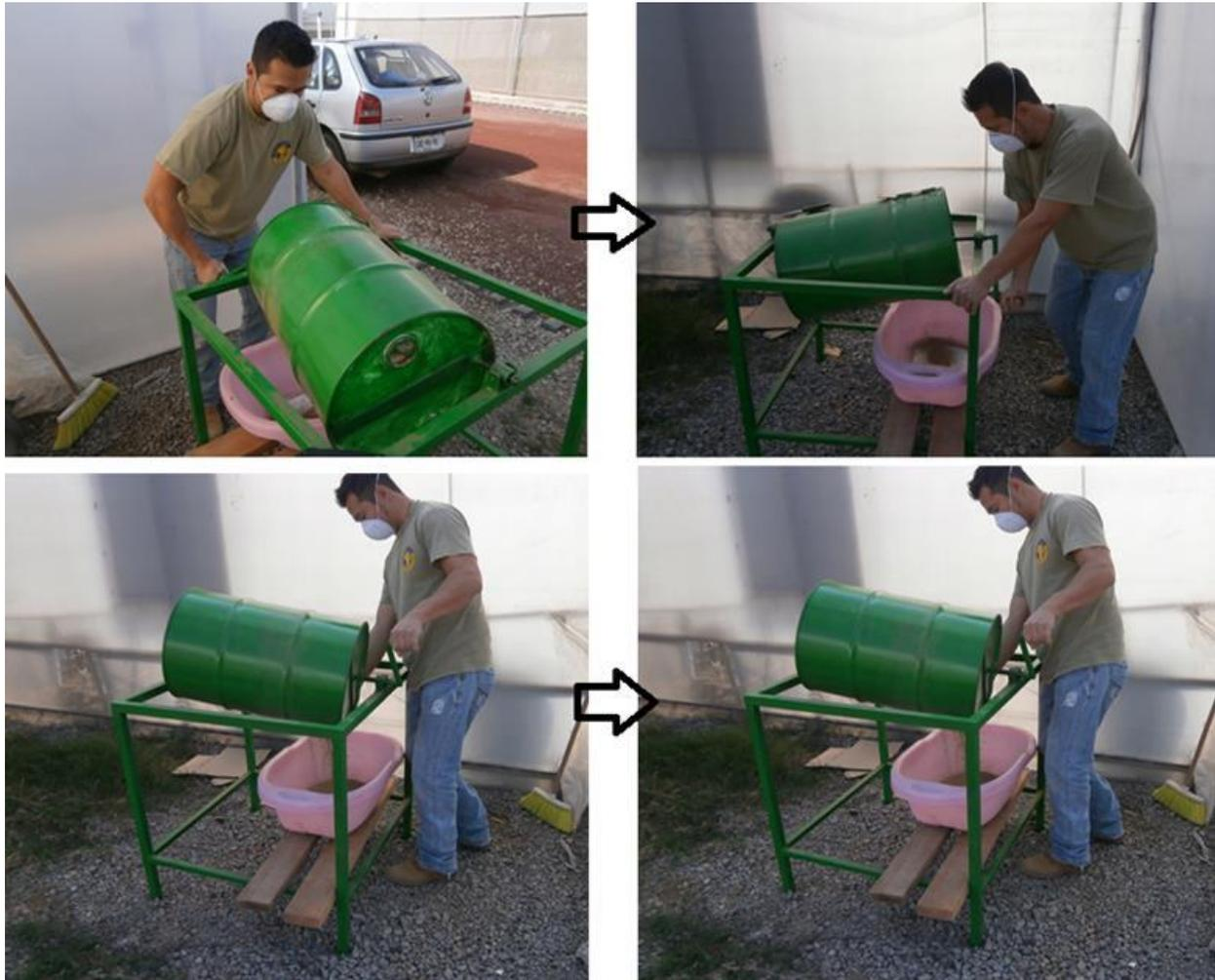
Figura 6. Revolvedora manual que se construyó para homogeneizar cada uno de los tratamientos de la presente investigación.
