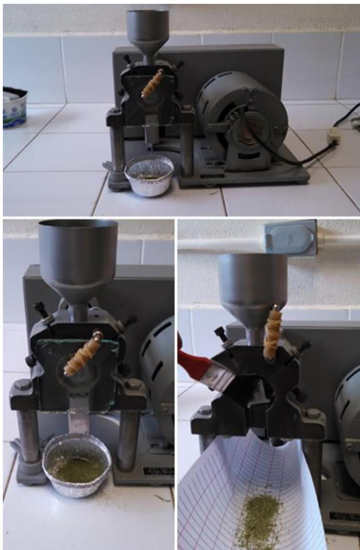
Figura 19. Proceso de molienda del pasto seco para la determinación del nitrógeno en el tejido vegetal.
