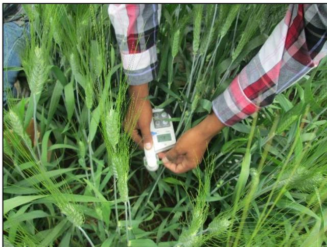
Figura 20. Medición en TRIGO con el equipo Spad 502 Plus
