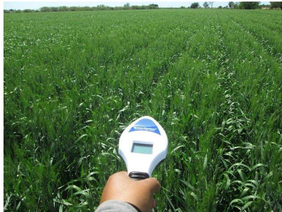
Figura 19. Medición de NDVI en cultivo de trigo con Greenseeker.
