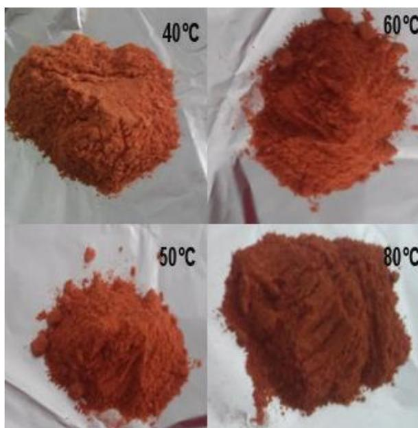
Figura 5.2. Polvos de jitomate obtenidos mediante secado por convección a diferentes temperaturas
