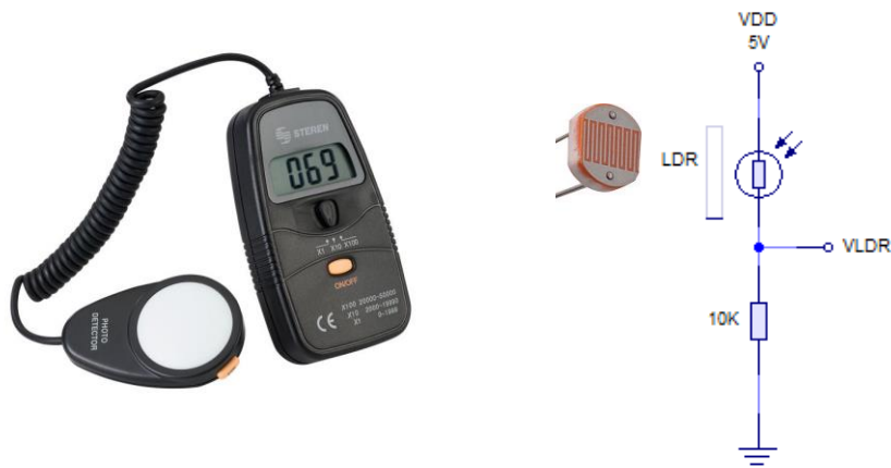
Figura 1.17. Imagen de luxómetro, foto resistencia y diagrama esquemático de su conexión por divisor de voltaje.
