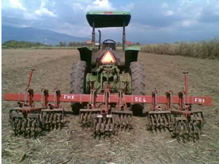
Figura 2. Rastra fitosanitaria para el control de huevos diapáusicos de mosca pinta en caña de azúcar.
