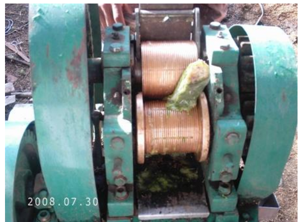
Fig. 14 Molino de rodillos para el machacado y extracción del líquido del nopal. Foto: Alejandro Hernández Santana.
