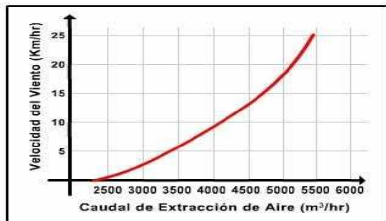
Fig. 18 Comportamiento de la expulsión de del extractor con la variación de la velocidad del viento. Fuente: Pruebas Industrias GM, Bogotá, Colombia. industriasgm@gmail.com
