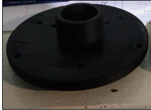
Figura 6.27. Buje impreso en 3D para la unión de los álabes Fuente: Elaboración propia
