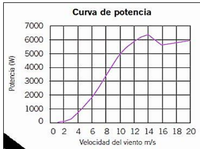
Figura 6.12. Curva característica del aerogenerador comercial Bornay 6000, que relaciona la potencia y la velocidad del viento
