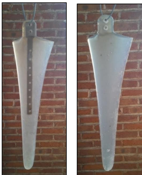
Figura 6.26. Álabes obtenidos mediante el proceso de inyección de resina
