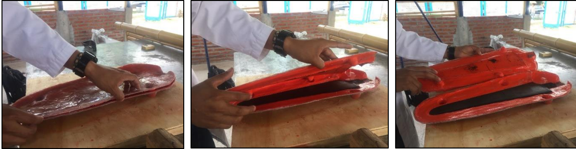
Figura 6.25. Molde construido para replicar los álabes Fuente: Elaboración propia
