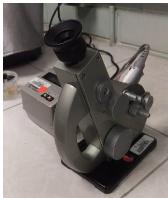
Figura 11. Refractómetro ABBE utilizado para determinación de índice de refracción de los extractos.
