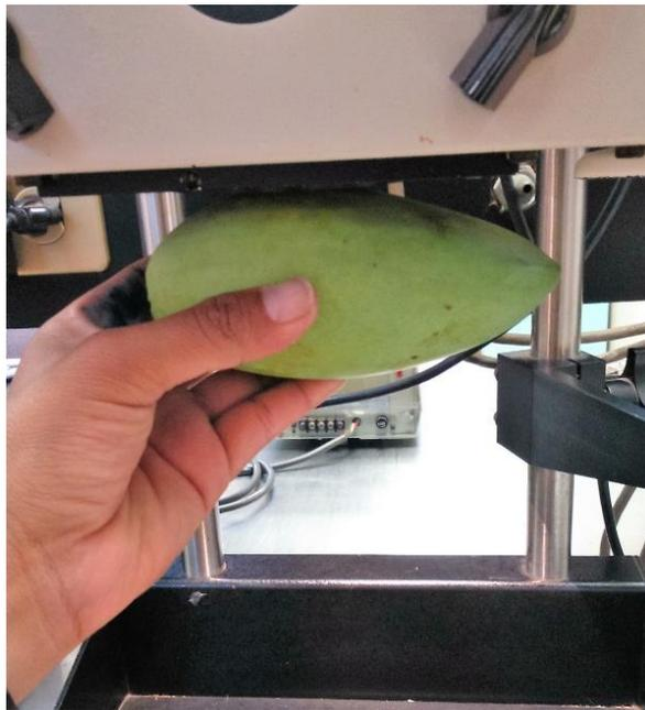
Figura 14. Colorímetro de reflexión Hunter L, a, b
