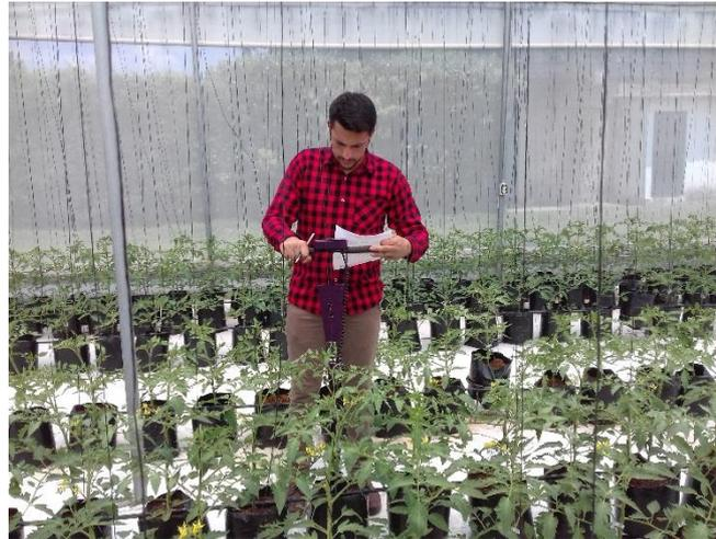
**Figura 30.** Medición de humedad con TDR 300 Fieldscout.
