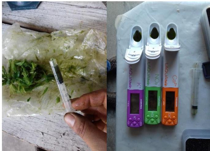
**Figura 43.** Extracción celular de peciolo y análisis en los ionómetros de  $\text{NO}_3^-$ ,  $\text{Ca}^{2+}$  y  $\text{K}^+$ .
