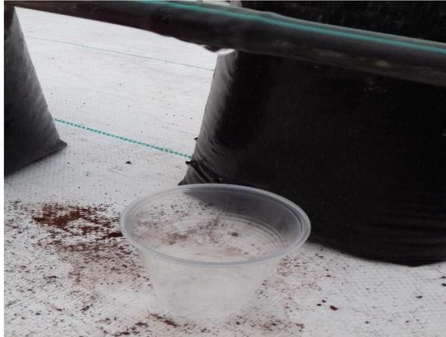
Figura 25. Prueba de uniformidad de riego.
