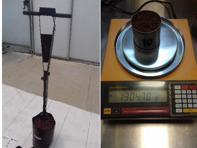
**Figura 27.** Medición con TDR y pesado de botes.
