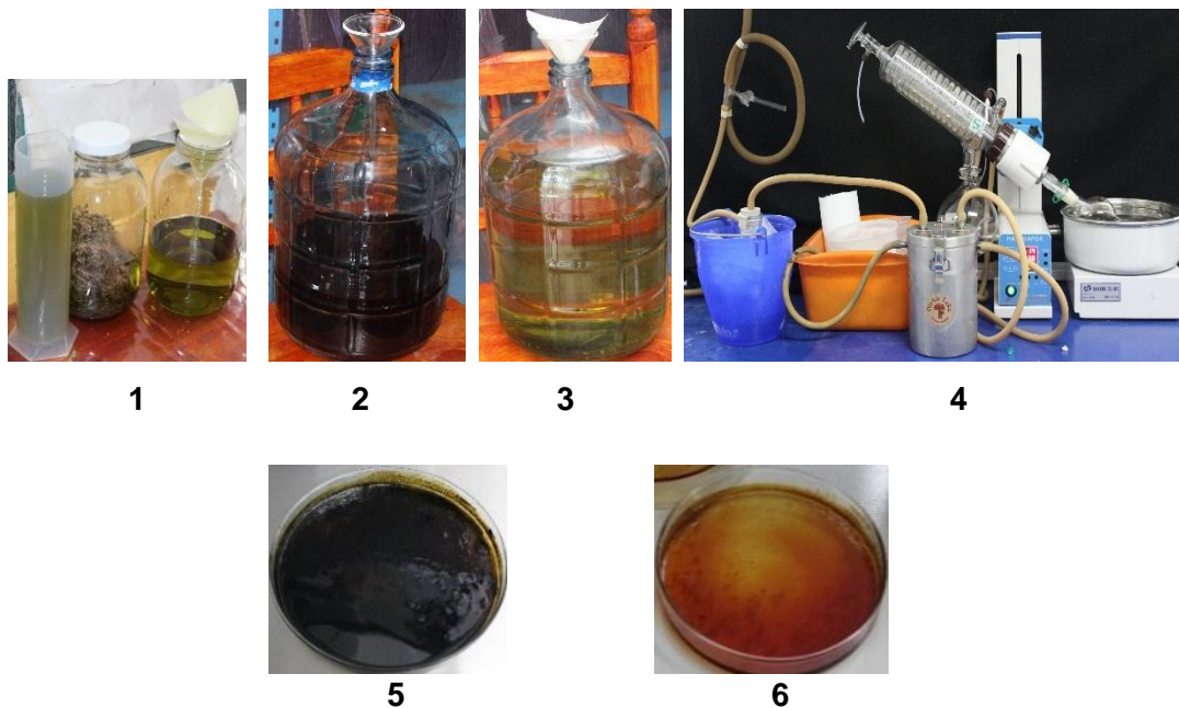
Figura 12. Macerados y concentración de extractos. 1: macerado de la sábila ( Aloe vera ) en etanol, grado reactivo. 2 y 3: sobrenadante del macerado de sábila y cebolla ( Allium cepa ), respectivamente. 4: concentración de extractos en el rotavapor (HAHN VAPOR, HANN SHIN). 5 y 6: concentrado de extractos de sábila y cebolla en cajas Petri, respectivamente.
