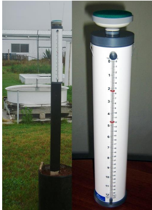
Figura 88. Atmómetro instalado en la estación meteorológica del Colegio de Postgraduados
