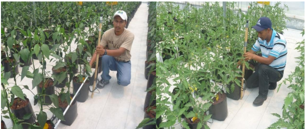
Figura 26. Medición de la RFA en chile poblano y jitomate con el interceptómetro
