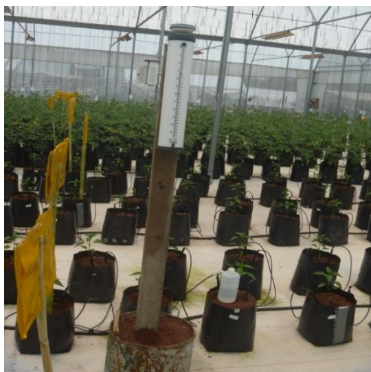
Figura 90. Instalación del atmómetro en el interior del invernadero
