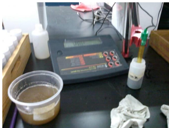
Potenciómetro modelo Hanna pH 210 empleado para la medición del pH de las muestras de suelo.
