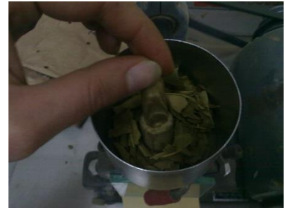
3.- Pulverizado de las hojas, mediante molino eléctrico.
