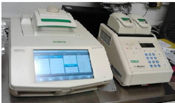
Figura 10. Amplificación del gen 16S rRNA mediante PCR empleando el Termociclador C100 Touch, (BIO-RAD, USA).
