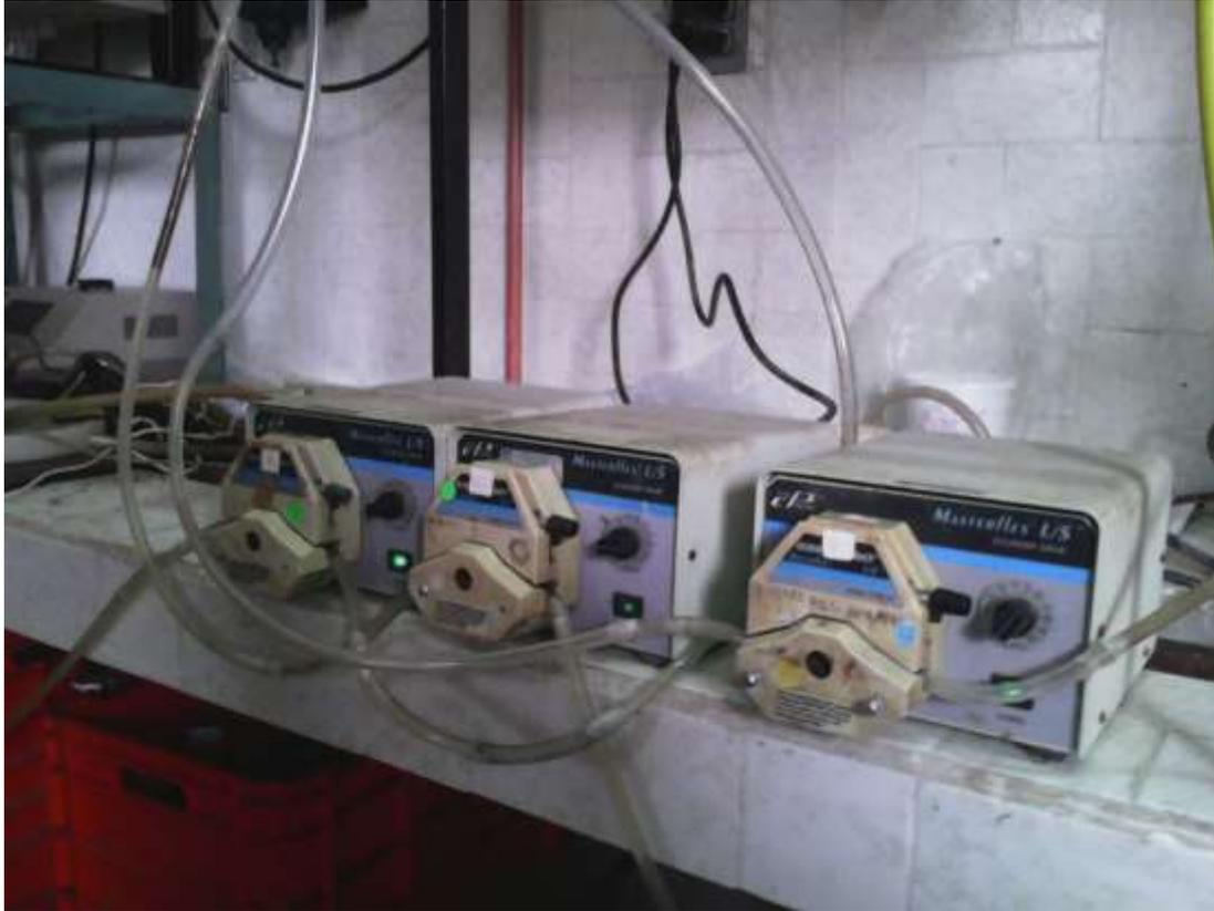
Figura 19 Bombas peristálticas utilizadas en la alimentación de agua cruda, recirculación de lodos y mezclado de lodos dentro del reactor biológico
