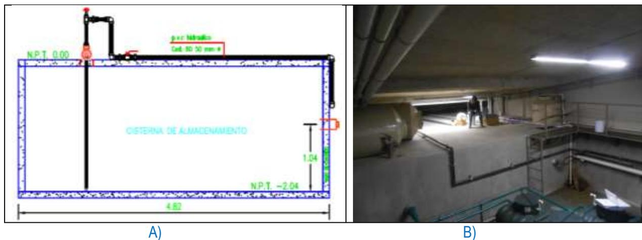
Figura 43 A) Plano arquitectónico de cisterna de almacenamiento y B) Cisterna construida
