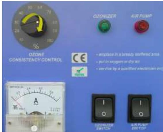
Figura 50 Tablero de Ajuste de producción de ozono
