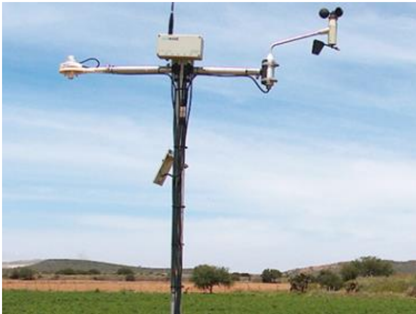
Figura 26. Sistema de medición y control con sensores meteorológicos
