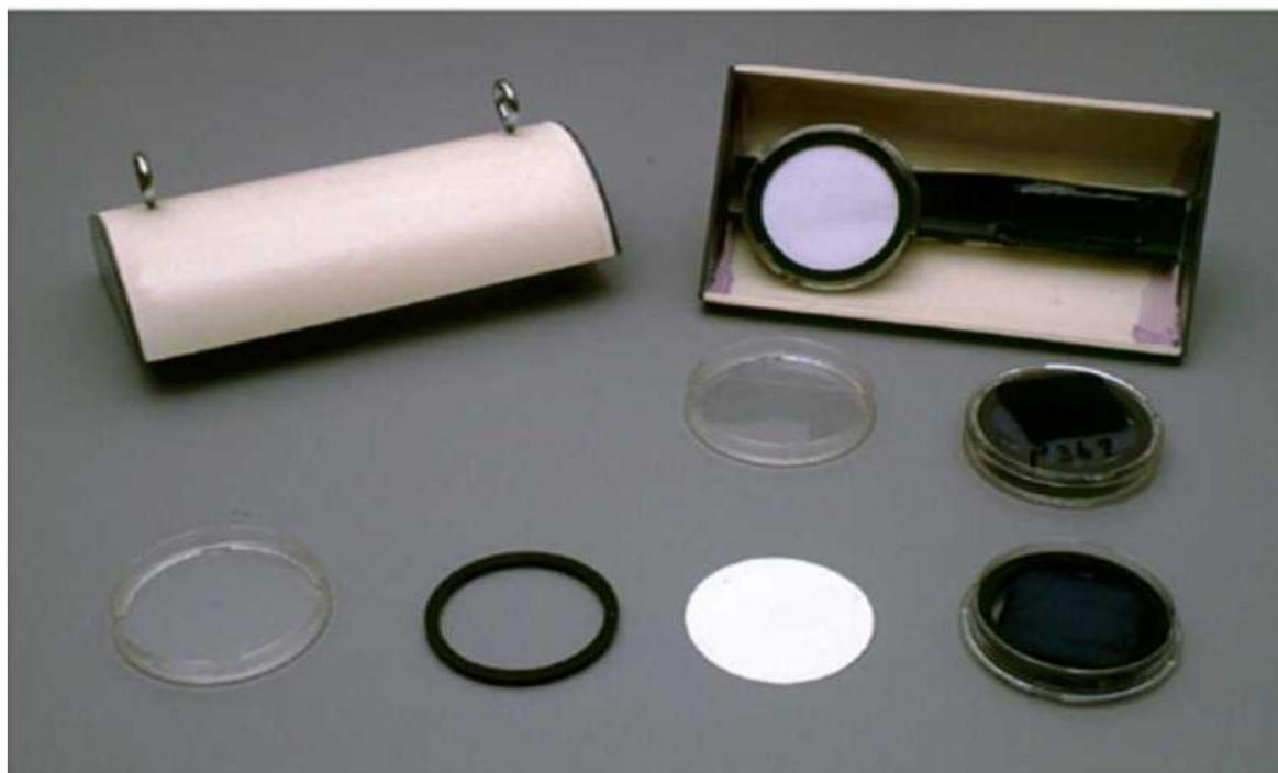
Figura I.1. Componentes de los monitores pasivos “Can Oxy Plates™” para medir ozono atmosférico.
