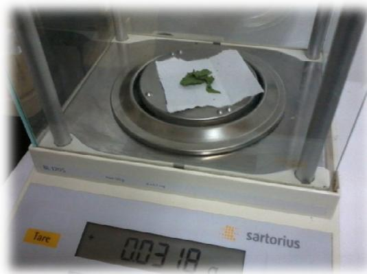
**Figura 7. Balanza analítica donde se obtenían pesos frescos y secos del presente proyecto.**
