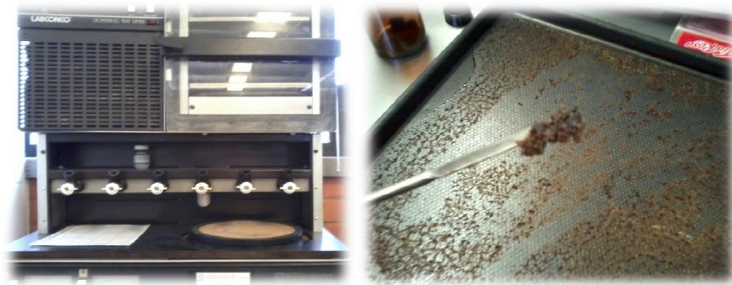
**Figura 4. Liofilizador y extracto liofilizado.**
