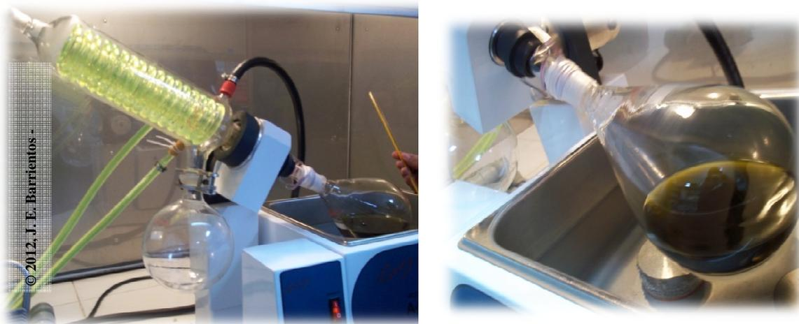
**Figura 5. Equipo rotavapor utilizado en la obtención de los extractos acetónico y etanólico.**
