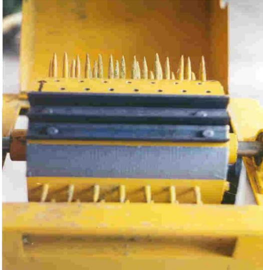
Fig. 24 .- Disposición de cuchillas limpiadoras en el cilindro.
