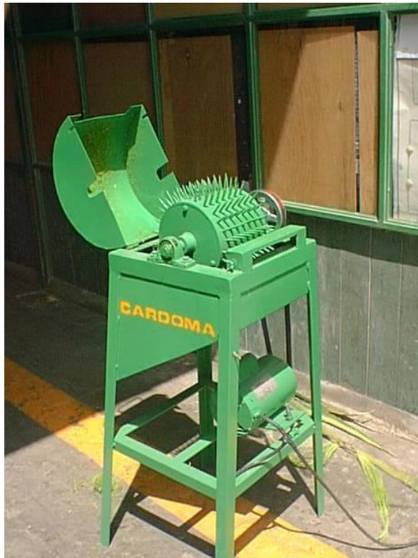
Fig. 18 .- Máquina desfibradora marca “Cardoma”.
