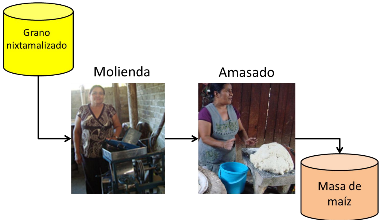
Figura 2.13. Procesos que intervienen para la obtención de la masa (incluye utensilios tradicionales).
