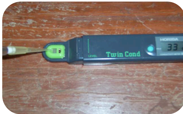
Figura 6. Conductímetro Horiba B-173 utilizado para la determinación de la conductividad eléctrica del medio de resuspensión.
