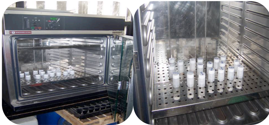
Figura 7. Muestras de raíz de pimiento “Bell” sometidas a estrés por alta temperatura y humedad relativa.
